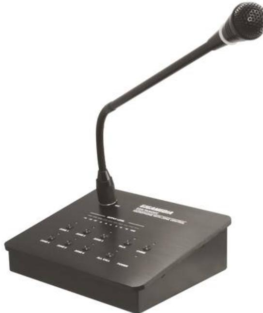
Le GGM PAM6MIC est un pupitre microphone qui permet de gérer l'ensemble des 6 zones des GGM PAM6120S3 et PAM6240S3. Il offre la possibilité de gérer de manière globale ou séparée chaque zone pour diffuser votre message. Il est possible de connecter jusqu'à 6 pupitres en cascade grâce au port RS485 (entrée et sortie) et de choisir le carillon 2-4 tons avant la diffusion du message vocale.
