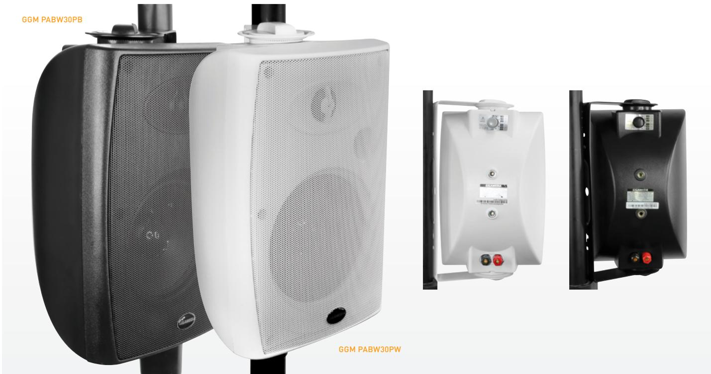
Ce haut-parleur à fixation murale inclut un transformateur 70 V / 100 V, ce qui permet de réduire la perte en ligne, d'augmenter les distances de transmission et offrir un raccordement en parallèle de plusieurs haut-parleurs.
