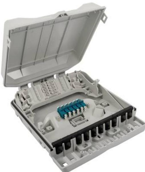
Ce boitier IP54 a été spécialement conçu pour un raccordement aisément des fibres optiques, via épissage fusion (60 fibres optiques) ou câbles drop pré-connectorisés (jusqu'à 12 fibres optiques - 6 raccords LC duplex).
