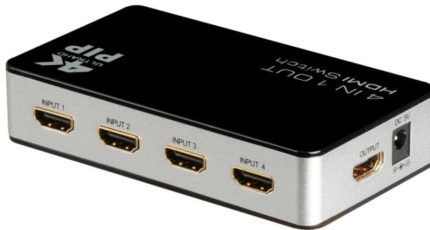
Ce produit permet de raccorder plusieurs sources en HDMI 1.4 sur un écran. Ideal lorsque l'afficheur de dispose pas de suffisamment d'entrées HDMI pour raccorder l'ensemble des sources. 2 types d'affichage: en choisissant sa source, ou en Picture in Picture: une source est affichée en grand et les 3 autres en simultané sur 3 petites vignettes.
