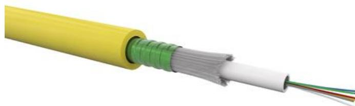
Câble intérieur / extérieur à structure libre (fibres 250 µm) armé acier, gaine LSOH. Doté d'un renfort acier, il est résistant à l'écrasement et peut être enterré directement. Décliné avec une gaine extérieure LSOH-FR B2ca, il est adapté aux environnements les plus exigeants en termes de performance au feu.
